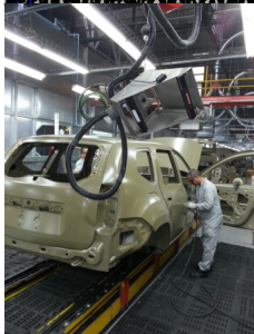
Fig. 12. Instalación de pintura automática en la planta de producción de pintura de la Neptun de los códigos de los chasis
